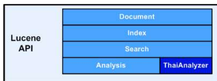
รูปที่ 5: โครงสร้างทางสถาปัตยกรรมของ Lucene API
